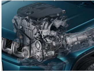
3. 4 CYL DOHC 2.0 LTR TURBO POWERTRAIN 221 HP 380 NM TORQUE
